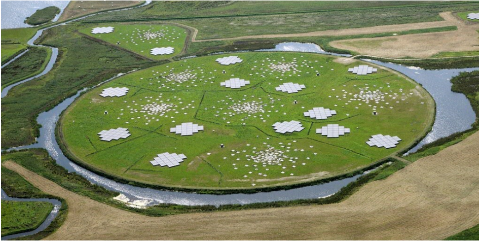
Figuur A: De 'superterp', de centrale 6 stations van de LOFAR-kern waaruit de AARTFAAC-6 configuratie bestaat die in dit proefschrift wordt gebruikt. Elk station bestaat uit een HBA-component, twee vierkanten van 24 antenne-tegels en een LBA-component, 96 antennes met een min-of-meer Gaussiaanse ruimtelijke verdeling. Foto: Aerophoto Eelde, 2011
